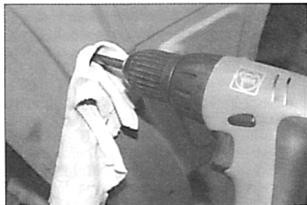
Beim Bohren großer Löcher in dünnem Blech verhindern Lappen wirksam das Verkanten!
