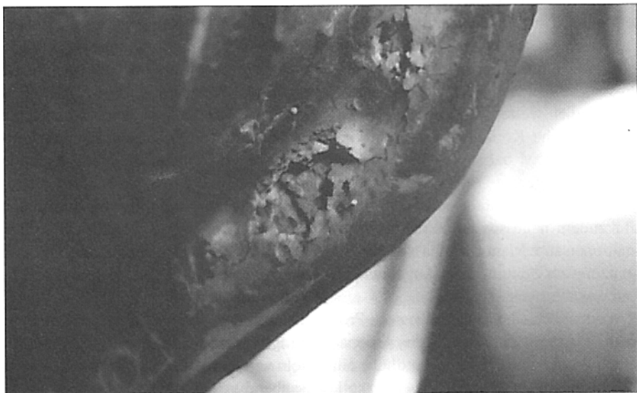
Rost am Längsträger auf der Beifahrerseite. Ohne Konservierung erwischt es jeden Manta-A!
