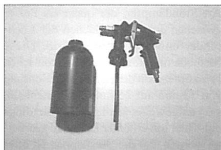
Mit der Druckbecher-Hohlraumpistole kann man kurze Zeit auch ohne Schlauch arbeiten
