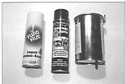
Die 3 Kandidaten des Hohlraumtests: Fluid Film, Teroson HV 200 und Mike Sander's
