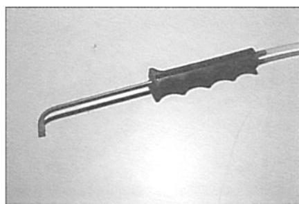
Feinste Spalte, Falze und Löcher lassen sich mit der "Eckendüse" sehr sauber behandeln
