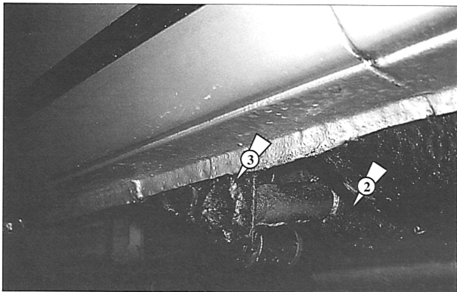
Die hintere Wagenheberaufnahme (3) ist direkt mit Stegblech und Längsträger (2) verbunden
