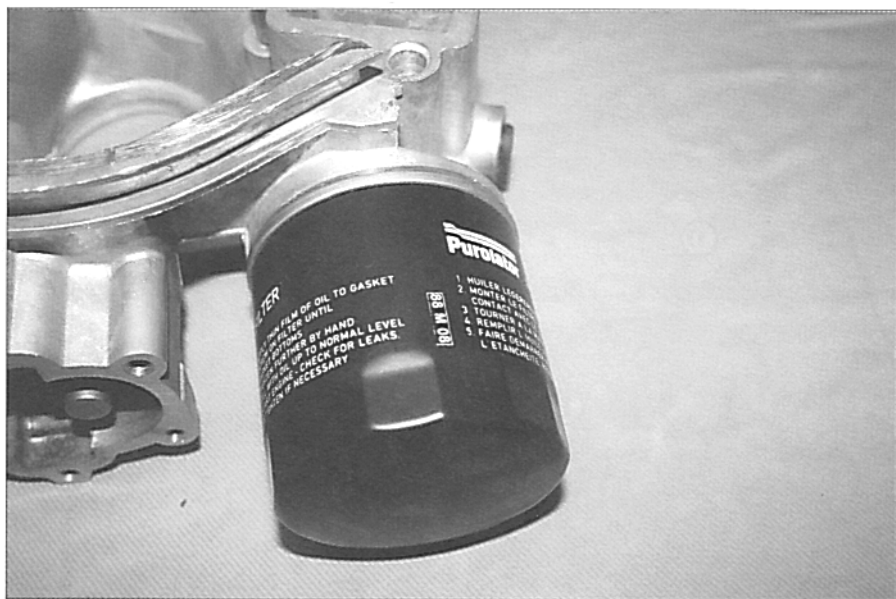
Der (dünnhäutige) Ölfilter am (ausgebauten) Steuergehäuse ist der Ölkühler des kleinen Mannes. Denn nur hier verlässt das heiße Öl den massiven Motorblock und kühlt leicht ab.
