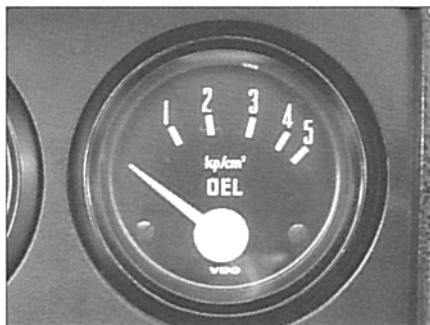
GT/E- und SR-Fahrer haben es doch schon besser. Neben der Öldruck-Kontrollleuchte können sie noch die Höhe des Öldrucks ablesen.
