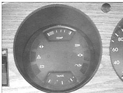
Der "normale" Manta-A Fahrer verfügt als Information zum Öldruck nur über eine Lampe die sagt: Öldruck vorhanden oder nicht.
